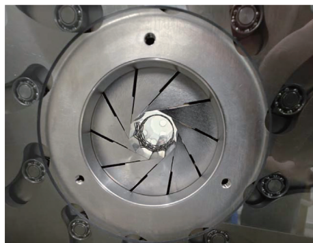
图 1 钴铬合金支架径向支撑力测试
