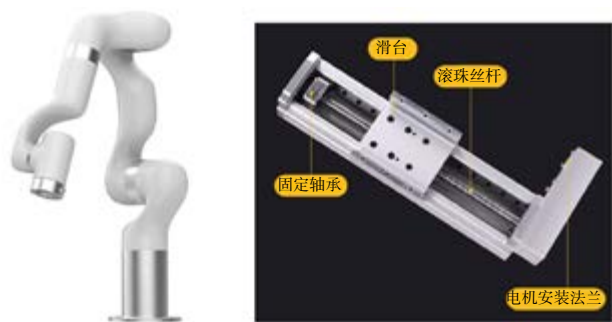
图 3 智能照护机器人的机械臂系统布局
