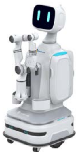
图 14 测试平台（带机械臂的智能照护机器人） Fig.14 Testing platform (intelligent care robot with robotic arm)
